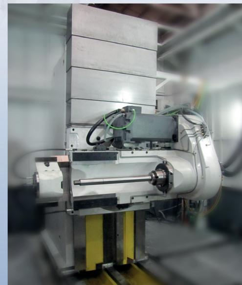
● 为适应大规格齿轮的高效强力切削，机床工作台壳体独立安装并与床身对接，切削力可直接传递到坚固的地基上。工作台采用大规格环形静压轴承支承，主传动采用双蜗轮蜗杆副结构，消除了啮合间隙，提高了工作台传动平稳性和传动精度。
