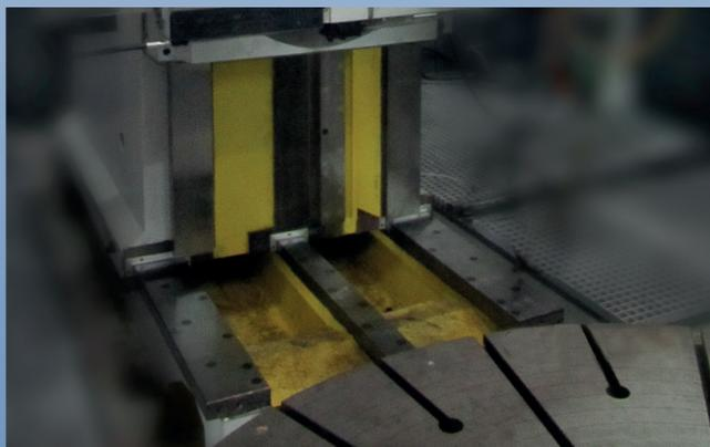
● 机床配有全封闭罩壳及油雾分离设备，可确保强力切削大流量冷却液产生的油雾能得到有效处理。
